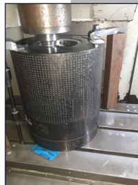
■ جوشکاری، ماشینکاری و سنگزنی Cage تعمیراتی
