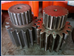
■ ساخت چرخنده و هزار خاری گیربکس فیدر میکسر
