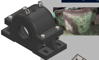
■ مهندسی معکوس Bearing Housing
